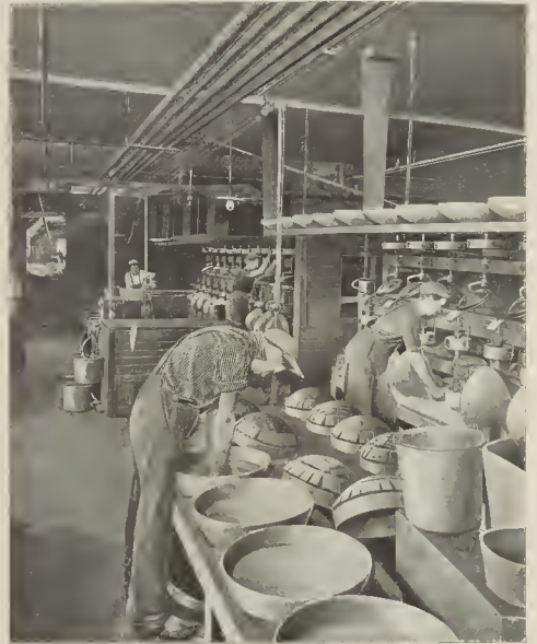
Fig. 3. - Máquina que pule simultáneamente centenares de lentes
